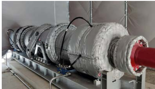
Abbildung 3: Montierte Gesteinskammer mit thermischer Isolierung.
